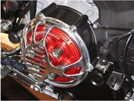
Frizione multidisco a secco di un motore Ducati
